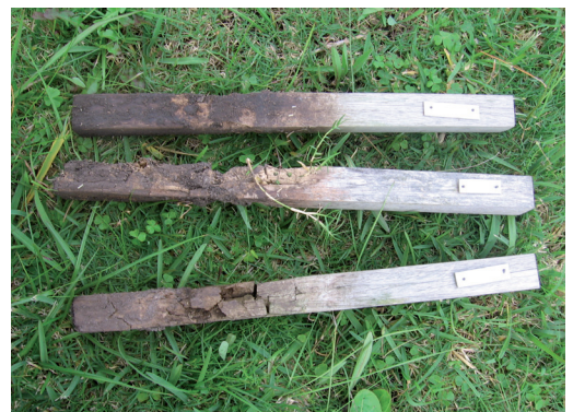
Ensayo de estacas en campo: a la izquierda evaluación de durabilidad natural de E. grandis ; a la derecha, estacas de E. grandis y Pinus spp. tratadas con CCA-C para evaluar durabilidad adquirida
