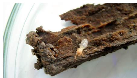
Daño por termita en estaca de pino enterrada en ensayo de campo (arriba) y termita obrera (abajo)
